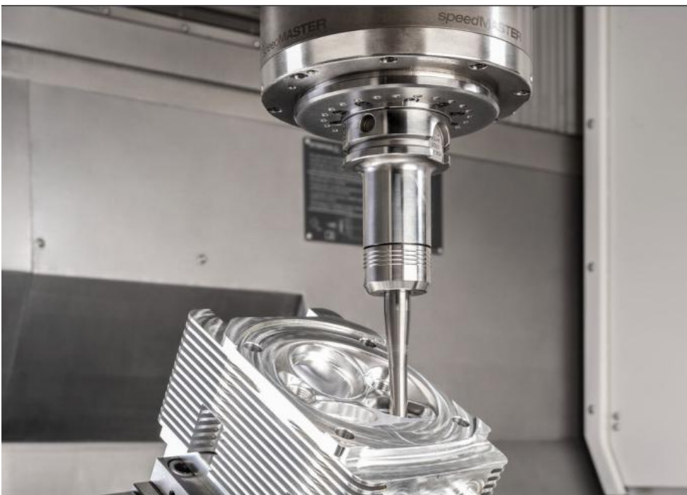
Bearbeitung eines Motorblocks auf der DMU 75 monoBLOCK mit PH Cell 300.
